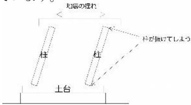
先日の熊本地震の際には1階部分が倒壊した住宅が報道されていました。左の図のように地震の揺れで柱が抜けてしまったことによる被害が多かったと思われます。
